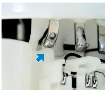
Fig. 2: Debido a la elevada presión del módulo de alimentación de combustible el cable se corta.
